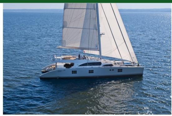
Tipo Moderno Propulsión Vela Casco Catamarán Eslora 31.1m (103') 12.0m (40') Manga Calado 2.5m (9') Construcción Aluminio
