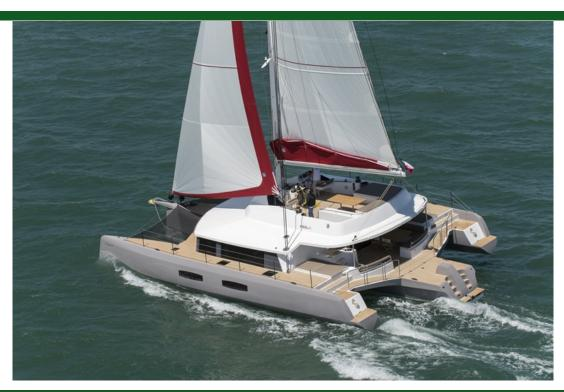
Moderno Tipo Propulsión Vela Casco trimarán Eslora 19.8m (65') 12.0m (40') Manga Calado 1.8m (6') Construcción Fibra de vidrio Motor 1 / Volvo / Potencia motor 150
