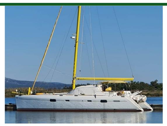
种类现代游艇类型帆船船身类型双体船载客量17.8m (59 ' )船宽9.2m (31')吃水1.7m (6')船身材料玻璃钢
