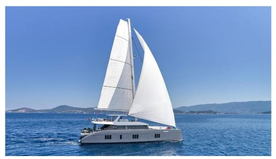
Moderne Type Propulsion Voile Coque Catamaran 23.9m (79') Longueur 11.5m (38') Largeur Fibre de verre Construction Moteur 2 / John Deere / 225
