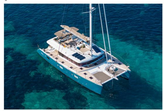
Type Moderne Propulsion Voile Coque Catamaran Longueur 18.9m (63') Largeur 10.0m (33') Construction Fibre de verre Moteur 2 / Yanmar / 4LV150 Puissance moteur 150
