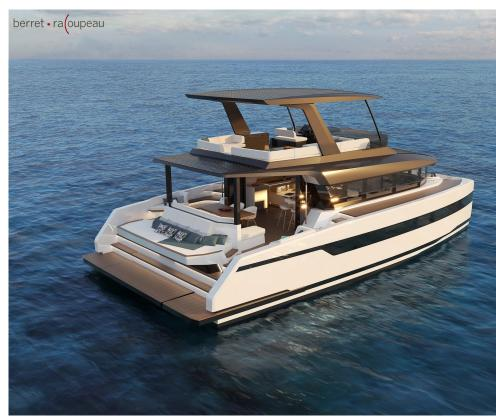
Type Moderne Propulsion Moteur Coque Catamaran Longueur 15.5m (51') Largeur 7.5m (25') Tirant d'eau 0.9m (3') Fibre de verre Construction Moteur 2 / Torqeedo /
