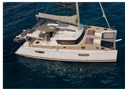
Type Moderne Propulsion Voile Coque Catamaran Longueur 15.0m (50') Largeur 8.0m (27') Tirant d'eau 1.3m (5') Construction Fibre de verre Moteur 2 / Volvo / D2-75 Puissance moteur 75
