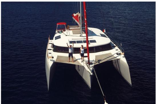
Type Moderne Propulsion Voile Coque Trimaran Longueur 15.6m (52') Largeur 8.9m (30') 1.8m (6') Tirant d'eau Construction Fibre de verre
