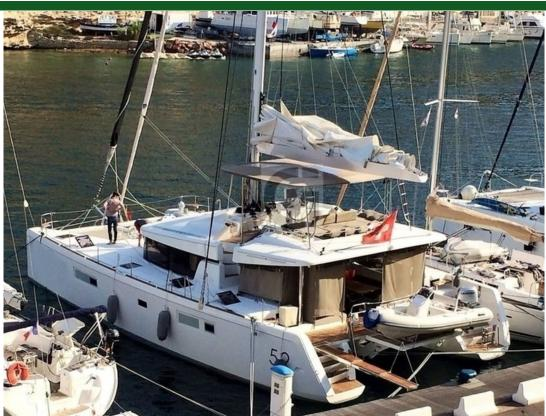
Tipo Moderno Propulsión Vela Casco Catamarán Eslora 15.8m (52') Manga 8.7m (29') Calado 1.5m (5') Construcción Fibra de vidrio Motor 2 / Yanmar / 4JH4-TE
