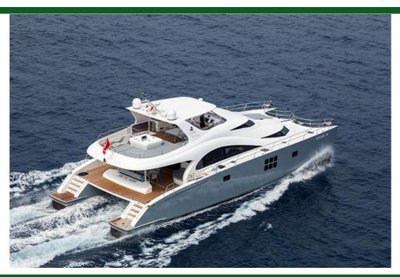
Tipo Moderno Propulsión Motor Catamarán Casco Eslora 21.4m (71') Manga 9.3m (31') Calado 1.2m (4') Composite Construcción 2 / Man / R6 Motor
