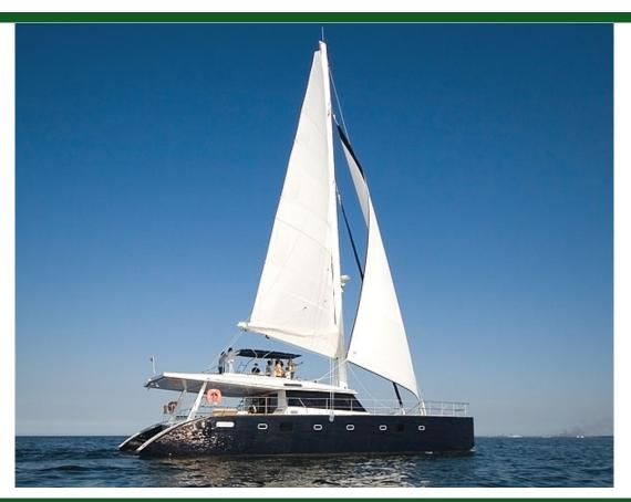
Tipo Moderno Propulsión Vela Casco Catamarán Eslora 18.3m (61') Manga 9.2m (31') Calado 1.6m (6') Construcción Composite Motor 2 / Yanmar / Potencia motor 110
