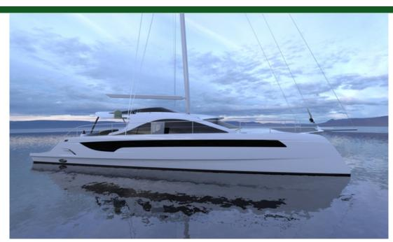
Tipo Moderno Propulsión Vela Casco Catamarán 19.5m (64') Eslora Manga 9.0m (30') Calado 0.8m (3') Composite Construcción Motor 2//
