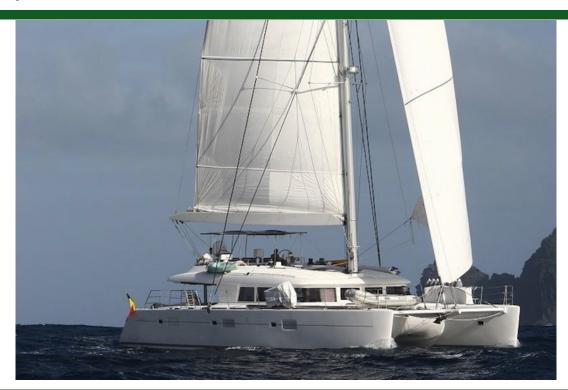
Tipo Moderno Propulsión Vela Casco Catamarán 18.9m (63') Eslora 10.0m (33') Manga Calado 1.6m (6') Construcción Fibra de vidrio 2 / Volvo / D3-150 Motor
