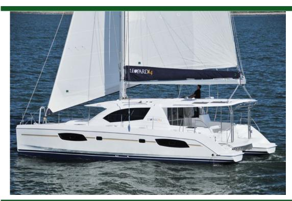
Moderno Tipo Propulsión Vela Casco Catamarán Eslora 13.0m (43') 7.3m (24') Manga Calado 1.2m (4') Construcción Fibra de vidrio 2 / Yanmar / 3JH5CE Motor
