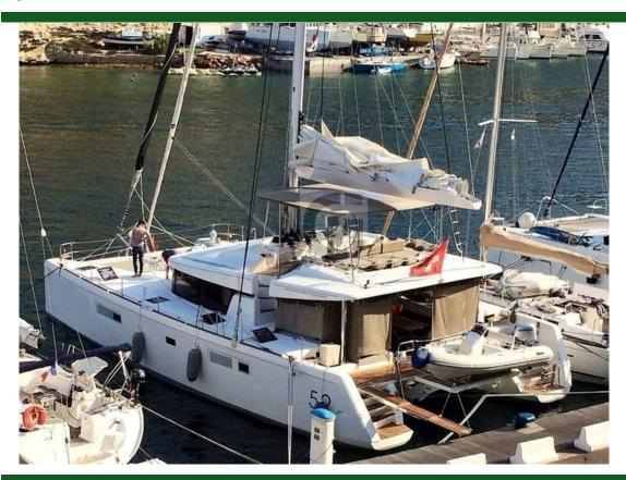
种类现代游艇类型帆船船身类型双体船载客量15.8m (52 ' )船宽8.7m (29')吃水1.5m (5')船身材料玻璃钢
