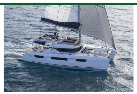
种类现代游艇类型帆船船身类型双体船载客量15.3m (51 ' )船宽8.1m (27')吃水1.4m (5')船身材料玻璃钢
