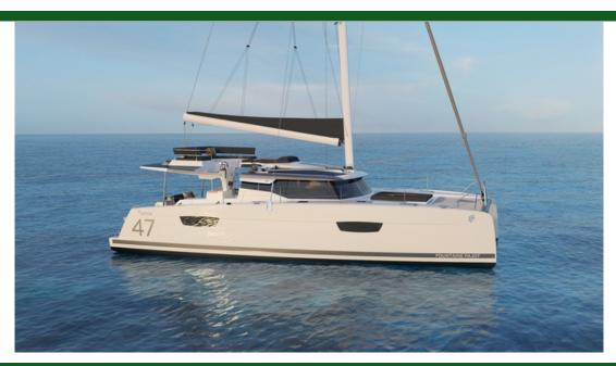
种类 现代 游艇类型 帆船 双体船 船身类型 载客量 13.9m (46 ') 船宽 7.7m (26') 吃水 1.3m (5') 船身材料 玻璃钢 发动机 2 / Volvo / D2
