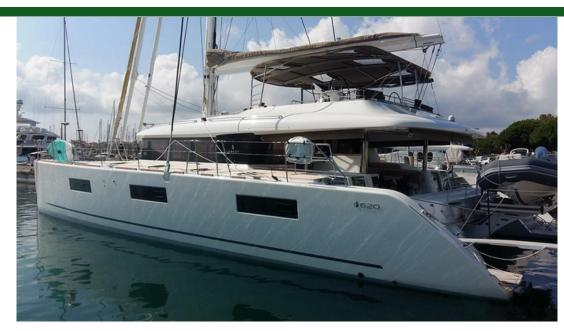
种类现代游艇类型帆船船身类型双体船载客量18.9m (63 ' )船宽10.0m (33')吃水1.6m (6')船身材料玻璃钢
