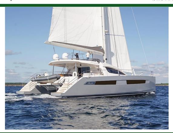
种类现代游艇类型帆船船身类型双体船载客量19.5m (64 ' )船宽9.2m (31')吃水1.8m (6')船身材料玻璃钢
