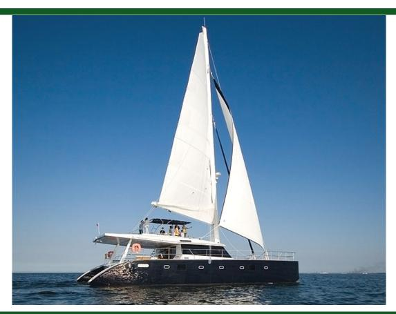
现代 种类 游艇类型 帆船 船身类型 双体船 载客量 18.3m (61 ') 船宽 9.2m (31') 吃水 1.6m (6') 船身材料 复合材料 发动机 2 / Yanmar / 发动机功率/HP 110
