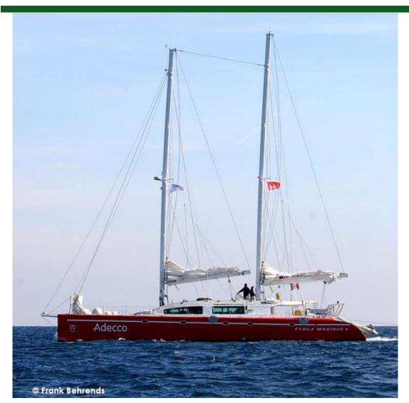
种类现代游艇类型帆船船身类型双体船载客量24.9m (82 ' )船宽11.5m (38')吃水2.1m (7')船身材料复合材料
