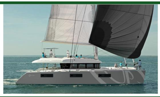
种类 现代 游艇类型 帆船 船身类型 双体船 19m (62.0 ') 载客量 10m (32.1') 船宽 吃水 2m (5.1') 玻璃钢 船身材料
