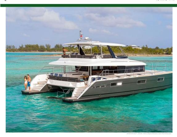
种类 现代 游艇类型 机动游艇 船身类型 双体船 载客量 19.5m (64 ') 船宽 10.0m (33') 1.1m (4') 吃水 玻璃钢 船身材料 发动机 2 / Volvo / D4-300
