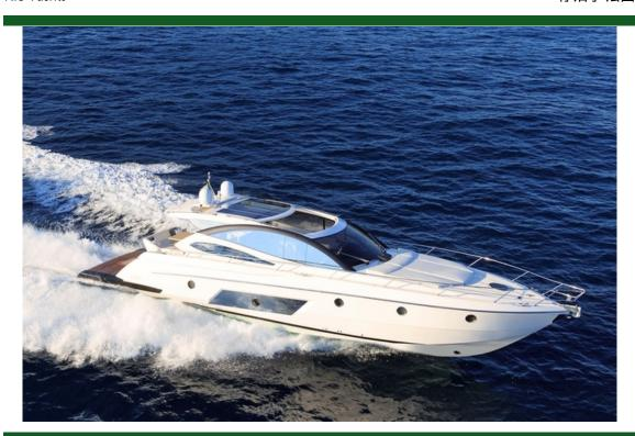
种类现代游艇类型机动游艇船身类型单体船载客量17.5m (58 ' )船宽4.6m (16')船身材料玻璃钢发动机2 / Man / I6-800
