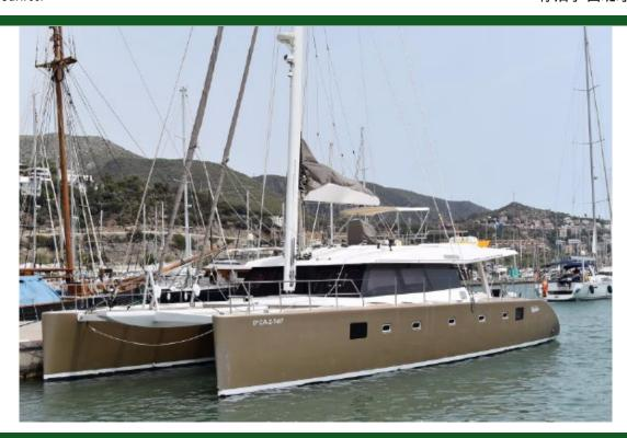
现代 种类 游艇类型 帆船 船身类型 双体船 载客量 19m (62.0 ') 船宽 9.3m (31') 吃水 1.6m (6') 复合材料 船身材料 发动机 2 / Yanmar / 125
