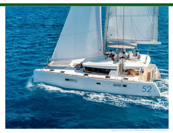
种类 现代 游艇类型 帆船 船身类型 双体船 载客量 16m (52.0 ') 船宽 9m (28.8') 2m (5.1') 吃水 船身材料 玻璃钢 发动机 2 / Yanmar / 4JH80
