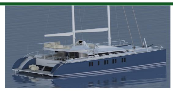
种类 现代 游艇类型 帆船 船身类型 双体船 载客量 24.9m (82 ') 船宽 11.5m (38') 吃水 2.1m (7') 船身材料 复合材料 发动机 2//
