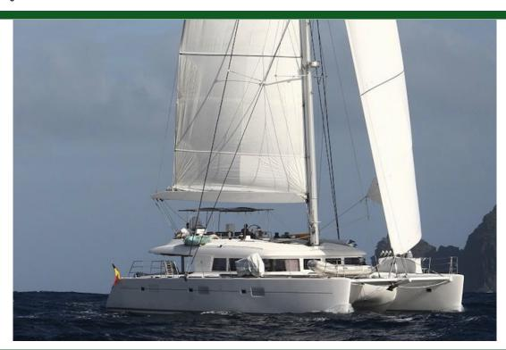
种类现代游艇类型帆船船身类型双体船载客量18.9m (63 ' )船宽10.0m (33')吃水1.6m (6')船身材料玻璃钢
