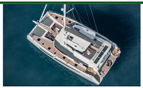
Tipo Moderno Propulsión Vela Casco Catamarán Eslora 18.8m (62') 9.5m (32') Manga Calado 1.6m (6') Construcción Fibra de vidrio 2 / Yanmar / 4LV150 Motor
