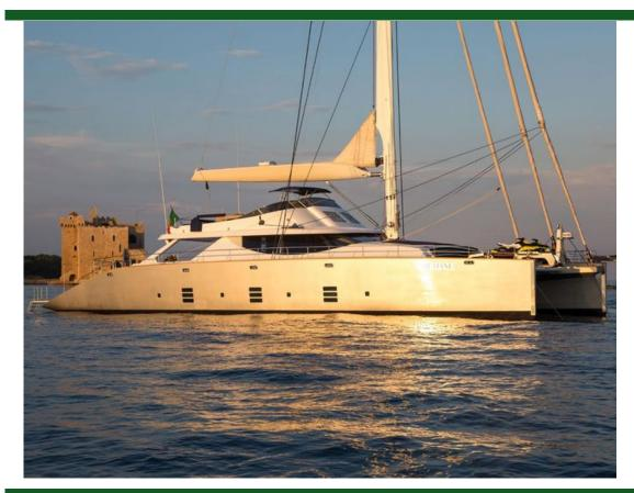
Tipo Moderno Propulsión Vela Casco Catamarán Eslora 31.0m (102') Manga 12.3m (41') Calado 2.0m (7') Construcción Aluminio 2 / Iveco / Motor Potencia motor 450
