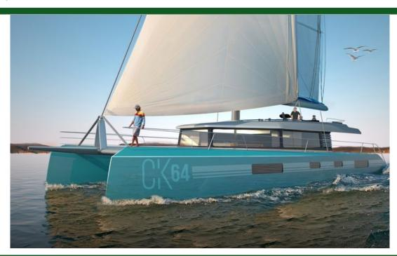
种类现代游艇类型帆船船身类型双体船载客量19.8m (65 ' )船宽9.4m (31')吃水1.5m (5')船身材料铝
