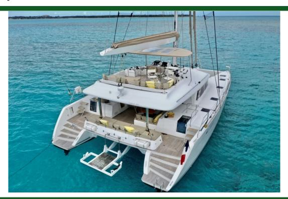
种类现代游艇类型帆船船身类型双体船载客量17.1m (57 ' )船宽9.4m (31')吃水1.5m (5')船身材料玻璃钢
