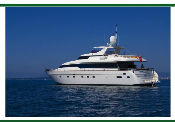
种类现代游艇类型机动游艇船身类型大型豪华游艇载客量27m (86.0 ' )船宽7m (20.8')吃水3m (8.2')船身材料玻璃钢
